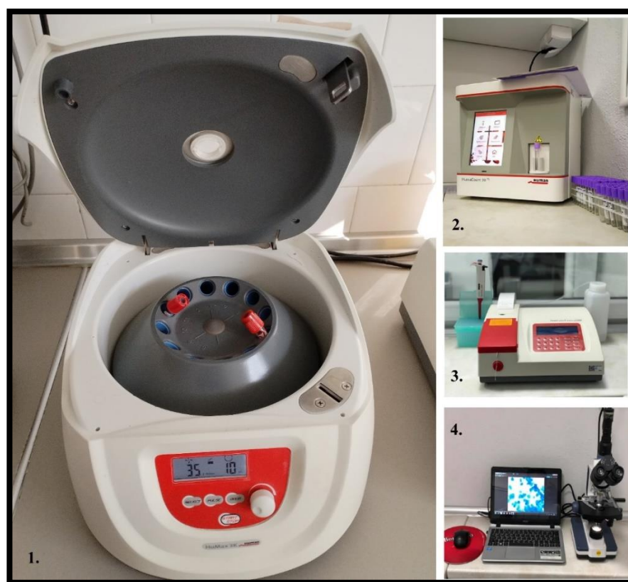
Слика 1. Основна лабораториска опрема: Центрифуга (1); Апарат за одредување на крвна слика (2); Апарат за основни биохемиски испитувања (3); Светлосен микроскоп (4)
